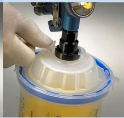
Зашелкните фиксаторы крышки к основанию адаптера, чтобы закрепить крышку бачка с краскопультом
