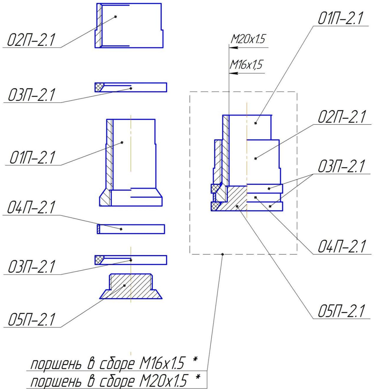
\* - резьба на штоке пневмоцилиндра (для 80 цилиндра - M20x1,5; для 63 M16x1,5)
