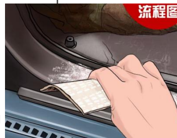
Шлифовка шпатлевки P120-P220
