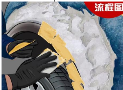
Удаление антигравия, шлифовка арок P100-P180
