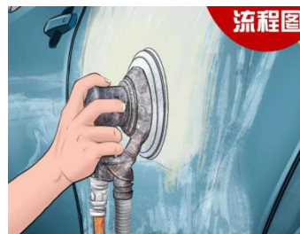
Удаление антигравия, шлифовка арок P100-P180
