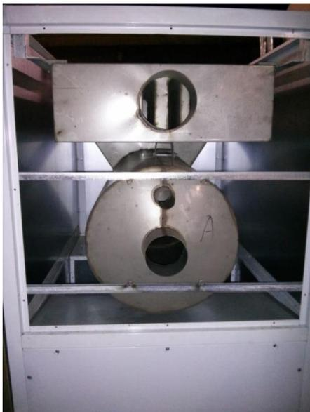
5. Продуманная конструкция теплообменника максимально отдает тепло от энергоносителя. В качестве энергоносителя может выступать дизельное топливо, природный газ или пар.
